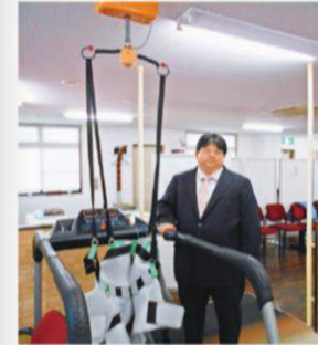
「Pウォーク」はリフトメーカーのモリトールと共同開発。歩行練習中の転倒防止に役立つ
